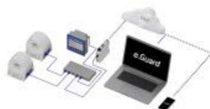
e.Guard-System mit smarten Wandlern, e.Guard-Gateway, optionalem Power Quality Monitoring und cloudb
