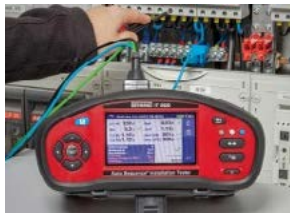
Installationsprüfung mit BENNING IT 200
